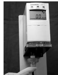
(4) Sostituzione dell'elemento filtrante
