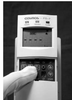
Aprire il coperchio sulla sezione di comando del corpo principale e tenere premuto l'interruttore a chiave "COMM" per più di un secondo.
