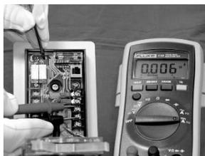
Misurare l'uscita analogica (corrente) di "G" e "H" sulla morsettiera TB1 utilizzando un tester, ecc. Se il valore rilevato rientra nell'intervallo indicato di seguito, passare al punto successivo. Se invece il valore non rientra nell'intervallo indicato di seguito, utilizzare la regolazione analogica del volume per la modalità di manutenzione 2 per farlo rientrare nell'intervallo indicato.
