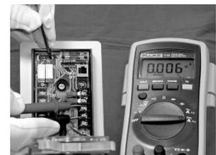
Misurare l'uscita analogica (corrente) di "G" e "H" sulla morsettiera TB1 utilizzando un tester, ecc.
