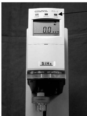
La spia di allarme (rossa) lampeggia insieme alla spia di allarme gas (1° livello) o a quella di allarme
